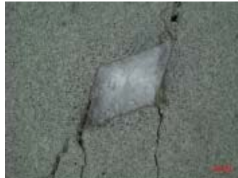
図 1 圧縮応力下における岩質材料の破壊プロセス(間隙氷有り)
