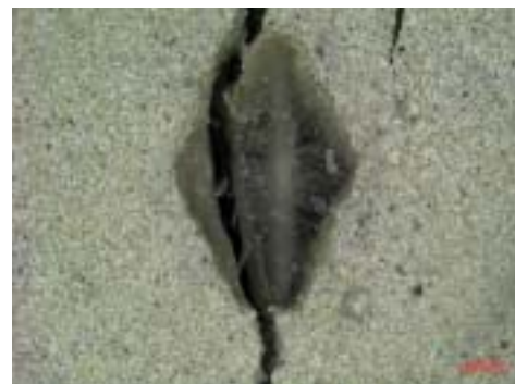
図 2 引張応力下における岩質材料の破壊プロセス(間隙氷有り)
