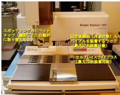
図2 セルアレイ標本自動作製機の全体図。これに制御用コンピュータが必要
