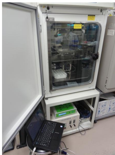
図 1 細胞に対する低酸素曝露装置
