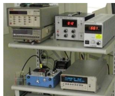
図3 測定システムの例(本システムでは上段のみを使用) 上段左から、エレクトロメータ(Keithley), 高压電源(応用技研), 高压電源(Matsusada) 下段左から、エレクトロメータ(応用技研), エレクトロメータ(Keithley)
