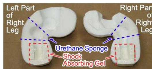
図1 ハイブリッド柔軟外装構造
