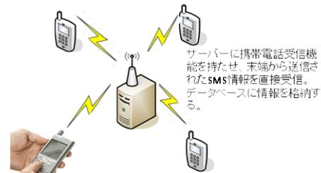
本研究により開発したプログラムにより出生・死亡情報の入力の後、プログラムがテキストに変換し、SMS (Short message service) により発信。
