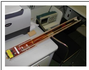
図 2 a : 製作した小動物用コイルの全体図
