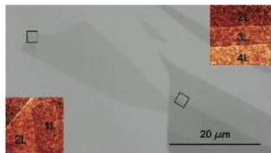
図2. 六方晶窒化ホウ素原子層の顕微鏡写真: 挿入図はAFMによる評価結果。中央の薄い灰色をしている部分が単一BNシートである。基板はシリコン酸化膜である。
