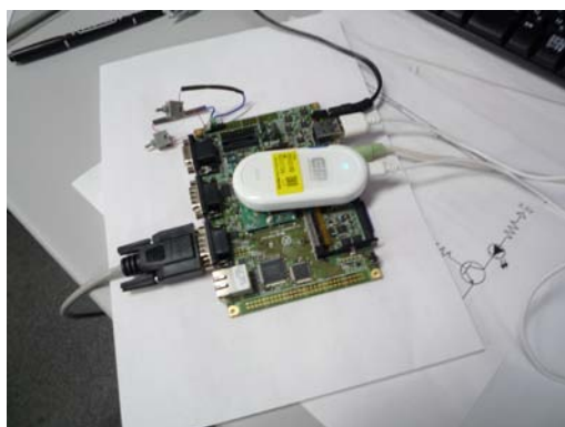
写真-1 Armadillo-500 を用いた端末
