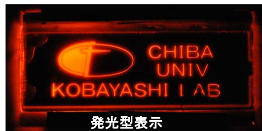
Fig.6. PEDOT系 EC- Ru 錯体 ECL 型 DMD 素子の各表示状態におけるデジタル画像
