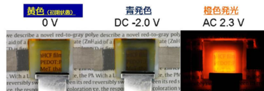
Fig.6. PEDOT系 EC- Ru 錯体 ECL 型 DMD 素子の各表示状態におけるデジタル画像
