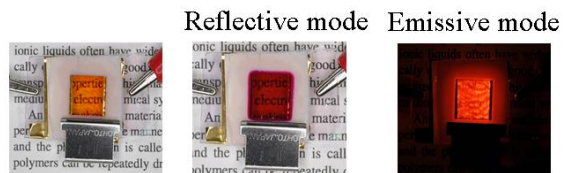
Fig.3. DMD 素子の着色状態における吸収スペクトルと発光状態における発光スペクトル (上)。各状態におけるデジタル画像 (下)。
