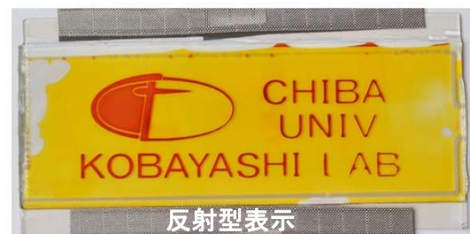
Fig. 7. 電子サイネージプロトタイプの反射型表示 (上) と発光型表示 (下)
