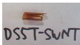
図 2 DS5T-5C を光反応で固定化した PVA フィルムの写真。着色はハイブリッドに由来する
