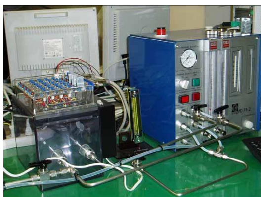
図 4. 製作した匂い計測装置
