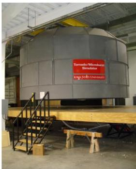
図 1 米国・アイオワ州立大学のトルネード・ダウンバーストシミュレータ
