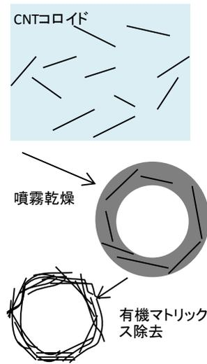
図 5 本研究の CNT マイクロカプセル作製プロセス
