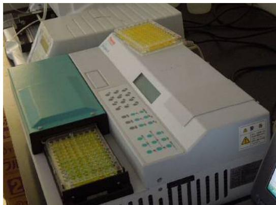
図 2。今回用いた ELISA 法でヒト血清を材料に反応させたもの。上は発色停止前の青色の状態。同一サンプルについて、二次抗体が IgM または IgG、阻害物質の使用の有無で 4 ウェル使っている。下は反応停止後、黄色に変化させ、マイクロプレートリーダーで読み取ろうとしているところ。
