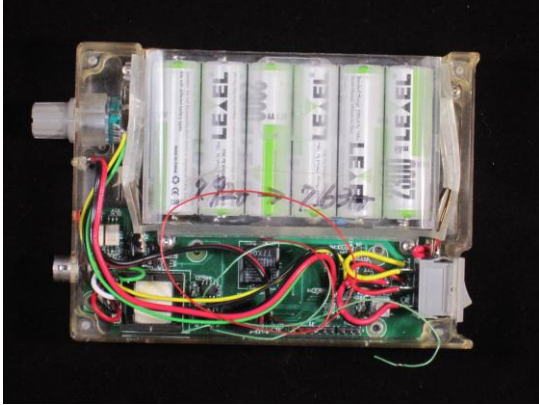
図 3：情報伝送機能を組み込んだ伝送信号用送信回路
