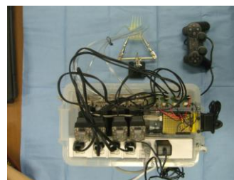
図6 電子基盤を組み込んだポンプシステム
