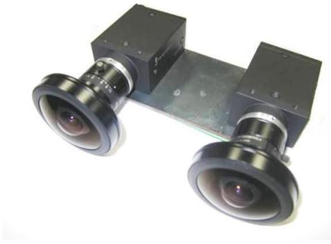
図4 2台の魚眼カメラを用いた水中計測装置。カメラ前方に広い計測範囲を有する。
