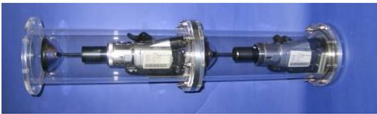
図5 2台の全方位カメラを用いた水中計測装置。カメラ周囲に広い計測範囲を有する。
