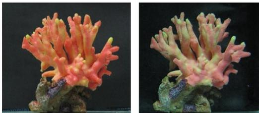
図 2 光の減衰. 画像の色がかすむ. 左図は空中, 右図は水中で撮影した様子. 全体的に色がかすむと同時に、特定の色(赤色など)は他の色と比較して特に目立たなくなる。
