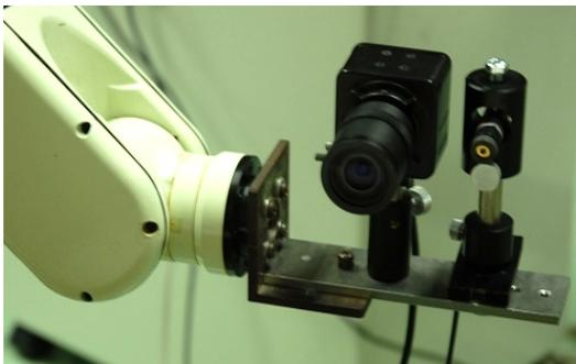
図7 レーザとカメラをマニピュレータ（腕型ロボット）の手先に取り付けた水中計測装置。マニピュレータによってレーザとカメラの位置姿勢を変化させながら水中物体の計測を行う。
