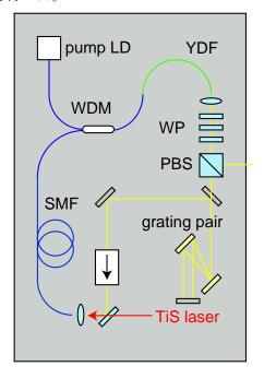
図1 ファイバレーザー発振器
