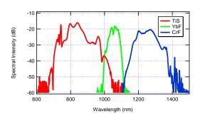
図6 3波長レーザーのスペクトル
