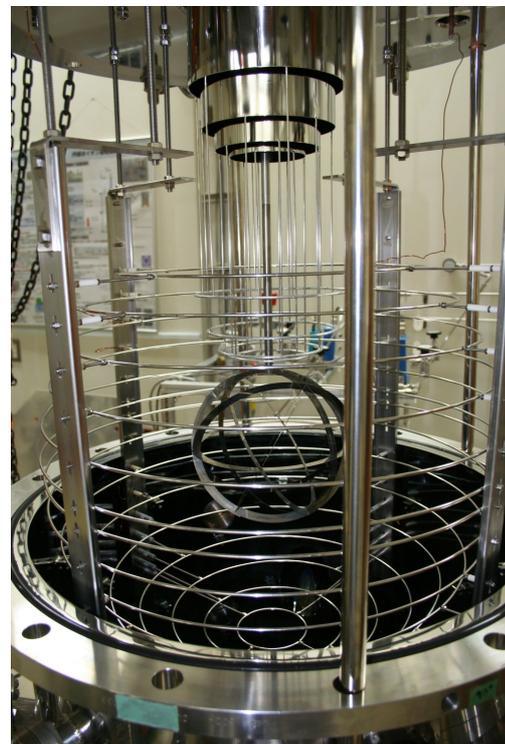
図 10 製作した多段電圧導入端子．5 段分割セラミック管と分割抵抗により，4 つの中間電極に電位を与える（上図）．これらの中間電極は 4 つの径の異なる 4 段の同軸円筒電極（下図）に接続されており，図 9 に示した電位分布を生成する．
