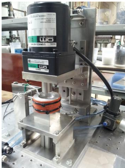
図1 開発した平行平板しゅう動試験機。ナノテクスチャによる傾き剛性の効果により、極めて狭いすきままで二面を平行に保ちながらしゅう動試験を行うことができる。
