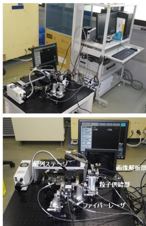
図5 本研究で開発した3次元粒子アセンブリシステム。上図は全体像、下図は配列部のみ。
