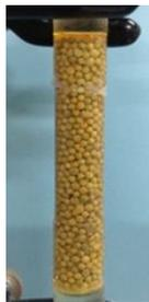
図 3 Pd(II)イオンの連続吸着実験後の固定層の外観
