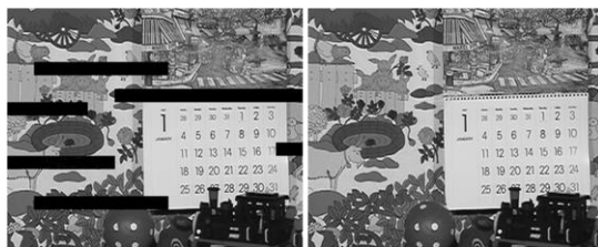
図4 左：パケットロスにより消失ブロックが発生した動画像，右：ワーピングを導入したカルマンフィルタによる復元結果
