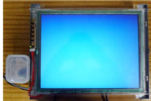
図1 開発したクリック感を伴うタッチパネルディスプレイ
