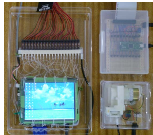
図4 開発したエアバッグ型触覚提示タッチパネルディスプレイ
