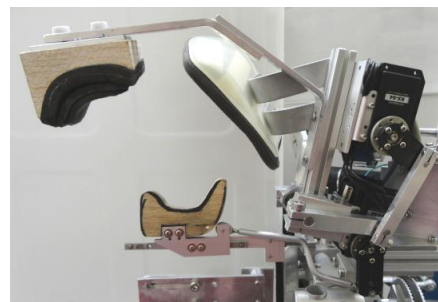
Fig. 5 肩甲骨把持機構の概略図
