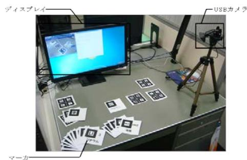
学習者は机上マーカの操作を行うことによって、仮想環境内での実験を行っていく。学習者の操作は図1右側のUSBカメラで撮像し、その映像をもとに仮想環境が構築される(図中ディスプレイ内の左上)。また、図のように様々なマーカを用意することによって、高等学校で行われている炎色反応実験、沈殿反応実験、イオン化傾向解析実験に対応でき、様々な化学反応を行わせるために試薬に対応したマーカも用意した。これらのマーカの種類、位置を組み合わせることで仮想環境内の実験機器を操作し、無機化学実験を進めていくことができる。図2に仮想環境内での実
