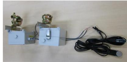
図10 本研究で行った基礎実験を基に開発されたセンサノード
