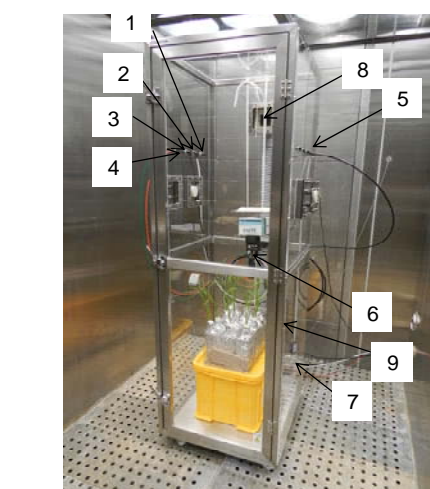
図1. 密閉式アクリルチャンバー(幅60 cm、奥行き60 cm、高さ180 cm、体積648 L)の見取り図(上)およびイネ(日本晴)栽培の様子(下)。1: 窒素ガス導入口、2: 酸素ガス入口、3: 非標識CO 2 ガス導入口、4: 13 CO 2 ガス導入口、5: ガス出口、6: 非分散型赤外吸収式二酸化炭素センサー、7: 温室度センサー、8: 換気ファン(チャンバー背面に設置、空気入口)、9: 換気ファン(チャンバー背面に設置、空気出口)。
