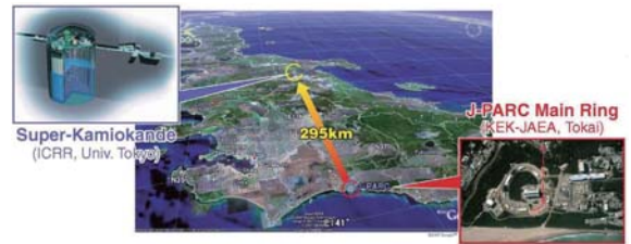
図 1: T2K 実験全体像: \nu ビームは茨城県東海村 J-PARC の \nu ビームラインで生成され、岐阜県飛騨市の東京大学神岡施設へ照射される。振動後の \nu フラックスは同施設の SK 検出器にて測定される。
