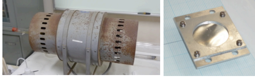
図2 水素炉中による試料の還元(左)と、融解・圧延の上で生成された錫標的(右)
