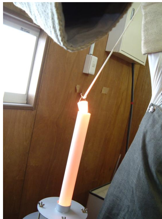
図 1. 酸素分圧制御型電気炉。試薬を白金ルツボにいれ QFM バフファの酸素分圧で全溶解させることで中央海嶺玄武岩を作成した。
