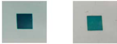
図 2. DT-SQ (左) 及び SQ1a (右) のエタノールトルエン (1/1, v/v) 溶液 (濃度: スクアリリウムユニット換算で 0.12 mM) で染色した酸化チタン電極の写真
