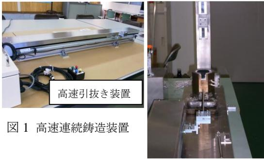
図 1 高速連続鋳造装置
