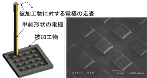
図2 自作放電加工機による機能性 \text{Si}_3\text{N}_4 セラミックスに対する放電創成加工例
