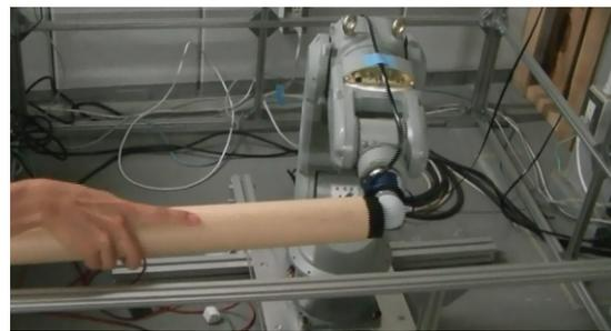
図 2：6 軸ロボットアームを用いた提案手法によるアドミッタンス制御。ロボットは、手先の接触力を 3[N] に保つように制御されており、実験者がロボットの手先を棒で軽く押している。ロボットの関節には手先換算で 10[N] 程度の摩擦があるが、提案手法によって、安定した接触と高い速応性が実現できている。ロボットは人が加える力に従って安全に動作している。
