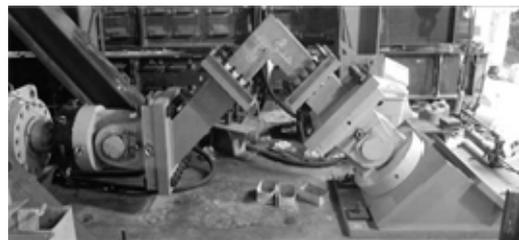
図7 実構造物を模擬した隅角部試験体実験の状況
