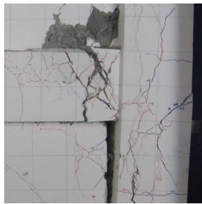
図 13 試験体 CWPS の損傷状況 (R=-0.03rad. 時)
