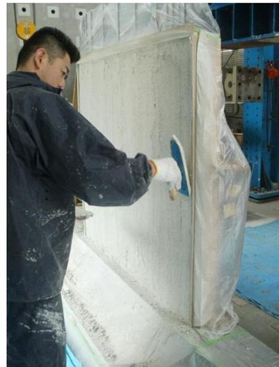
写真-1 PCM塗付け状況
