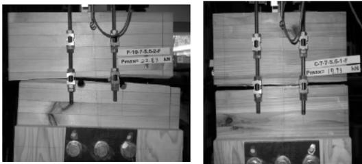
図 12 破壊状況(格子配置ボルト接合)
