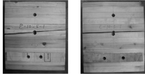
図9 破壊状況(複数列ボルト接合)
