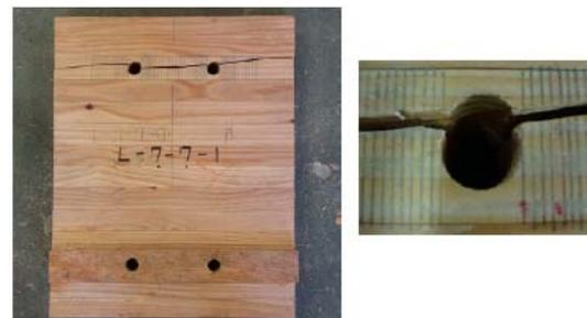
図6 破壊状況(複数行ボルト接合)
