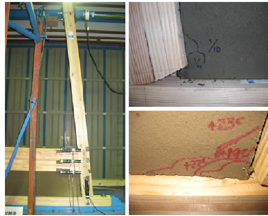
写真 3 垂壁付き独立柱の破壊状況
