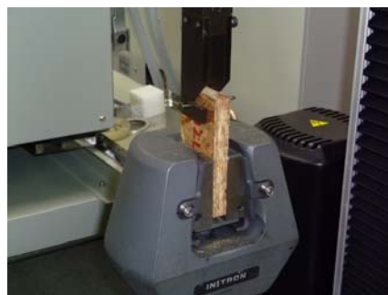
図3 側面抵抗試験
