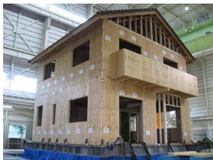
図1 新築木造住宅の耐震実験
