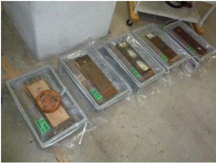
図5 試験片の水中浸漬処理
