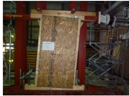
図8 劣化処理した耐力壁の面内せん断試験
