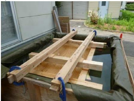
図7 耐力壁の水中浸漬処理の様子
