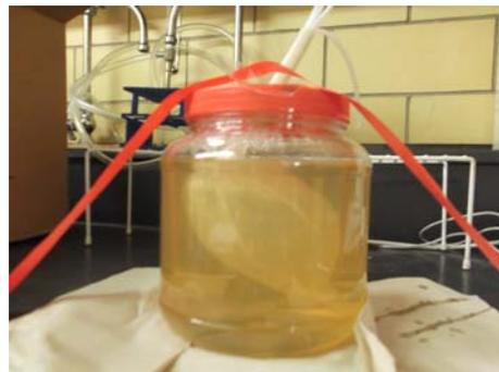
図 3. 3次元ゲル線量測定の様子。アプリーケータ内には Ir-192 線源が走行し、アプリーケータ外の線量を測定することが可能である。図 4 は 3次元ゲル線量測定の結果である。比較的均一に照射されているが、アプリーケータから離れた場所では線量が小さい。照射法をさらに検討するとともに、シミュレーション計算により最適化を図る必要がある。
