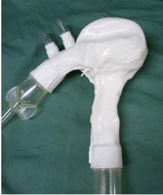
図5 シリコン製弓部大動脈瘤モデル
