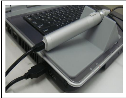
(Figure. 3) ノートパソコンに USB 接続した内視鏡 (ファイバースコープ)
