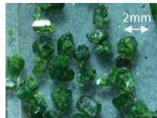
図3、作成した RFe_3(BO_3)_4 単結晶
