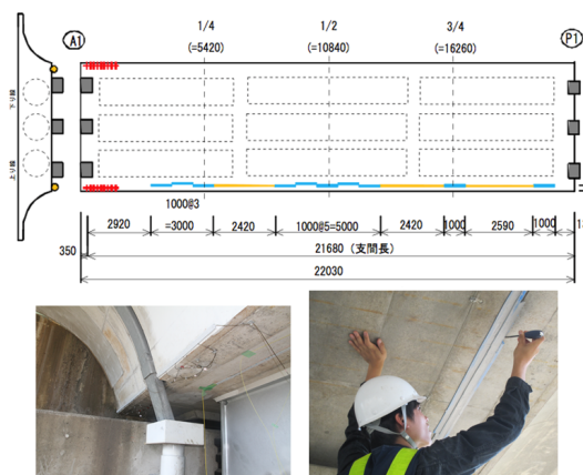
図2 実橋梁での光ファイバセンサ計測
