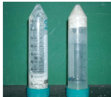
図8 3日養生したカルサイト析出ガラスビーズ(左は養生なし)
