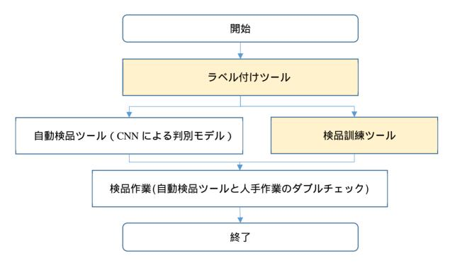
検品対象製品に対し、1のラベル付けツールで良品 / 不良品の判断基準を設定する. 具体的にはいくつかのサンプル画像を登録してそれぞれの判定結果とその根拠を記録する. 記録作業は複数の熟練オペレータが行い, 判断結果が異なる場合もそれぞれの根拠を記録して比較し最終判断はラベリングツールを利用する全ての熟練作業者の承認を得たうえで実施する. これによって熟練作業者の判断基準が平準化され,また良品 / 不良品の根拠も明確になった. ラベル付ツールで設定したサンプル画像のデータは2の検品訓練ツールと3の自動判別ツールに用いられる. 訓練ツールでは作業者ごとの判断の傾向と,サンプル毎の傾向を解析し,判断にばらつきのあるサンプルに対しては再度ラベル付けの検討を行い,自動判別ツールの学習データに追加してモデルの再構築を行う.
