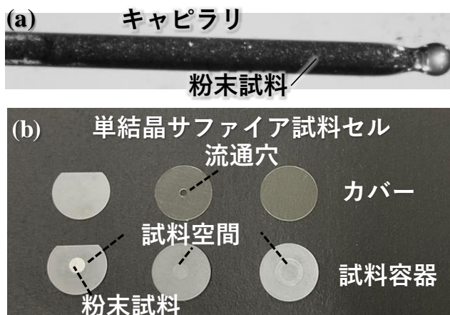
図2. (a)粉末回折測定に汎用的に用いられる石英キャピラリ。(b)本研究で開発した単結晶サファイア試料セル[2]。
